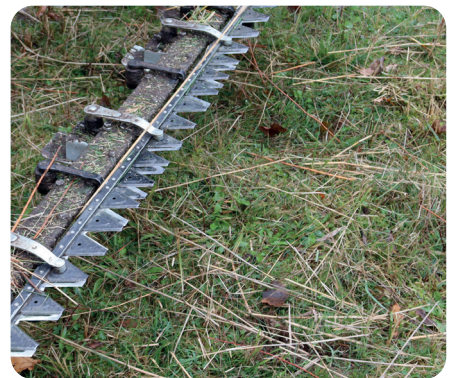
Messerbalken reduzieren Insekten-Verluste
