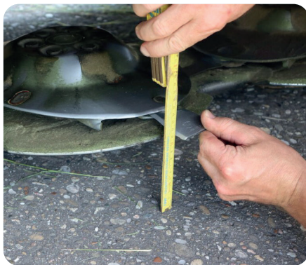
Einstellung der Mahdhöhe an einem Kreismähwerk
