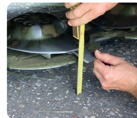
Einstellung der Mahdhöhe an einem Kreiselmähwerk
