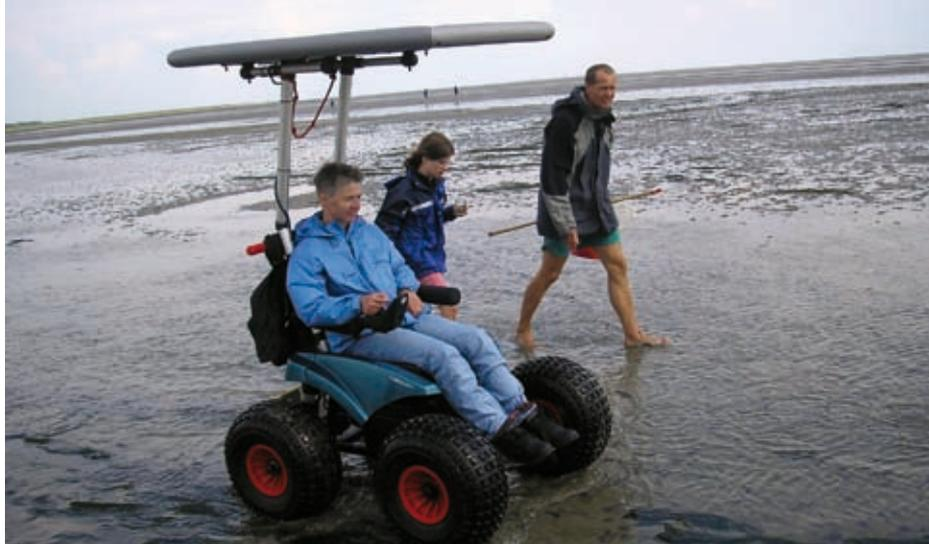
Die Breitreifen des solarunterstützten Rollstuhls üben weniger Druck auf den Boden aus als ein menschlicher Fuß
