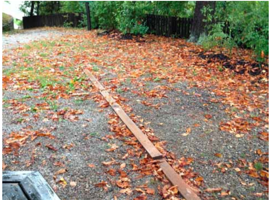
Mit dem Blindenstock ertastbare und Orientierung gebende Bodenschwellen im Naturpark Purkersdorf Tactile paving in Purkersdorf Nature Park, to be touched with white canes, helps give orientation
