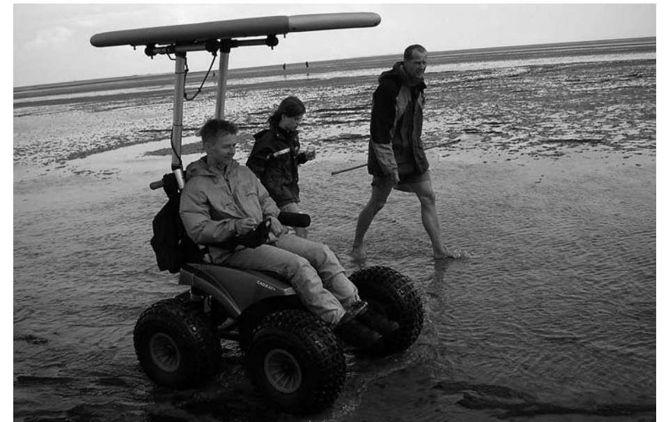
Die Breitreifen des solarunterstützten Rollstuhls üben weniger Druck auf den Boden aus als ein menschlicher Fuß
