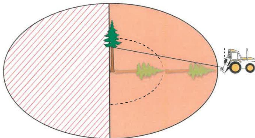
Bild 2: Fallbereich bei Seilsicherung oder starkem Vorhänger
