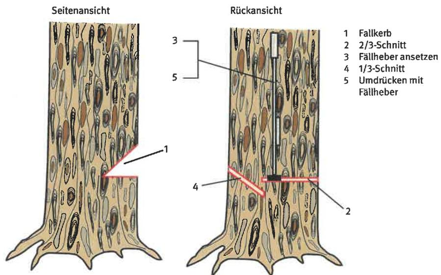
Bild 6: Fällheberschnitt
