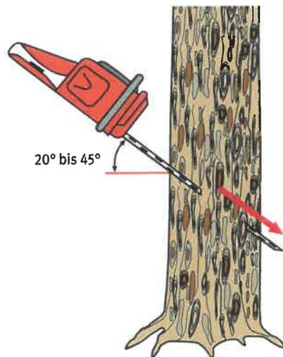
Bild 4: Schrägschnitt im Schwachholz (bis BHD 12 cm)
