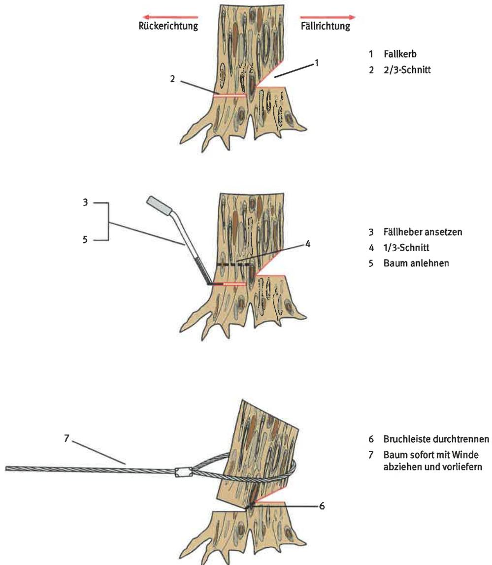
Bild 7: Kombiniertes Seillinienverfahren mit Fällheberschnitt
