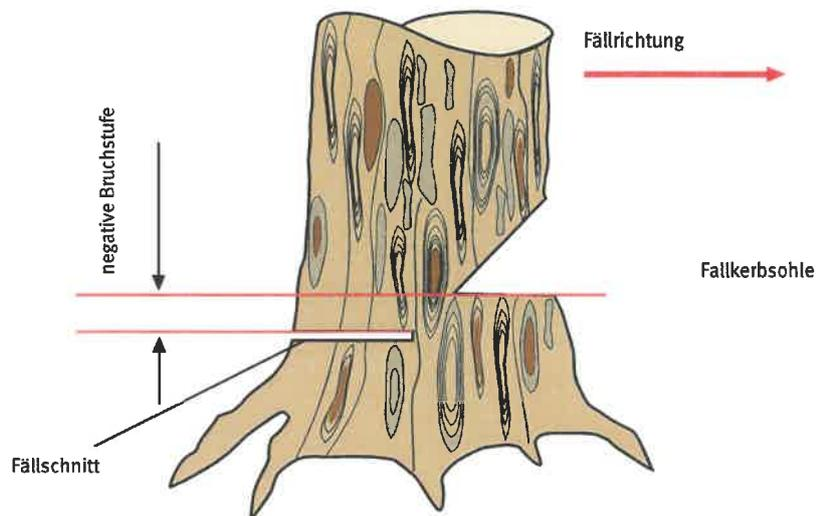
Bild 5: Versetzter Schnitt – negative Bruchstufe
